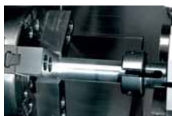
Position 3: Stangengreifer hat das Material im Eilgang (30 m/min) auf die gewünschte Position gezogen, Signal: Futter automatisch schließen
