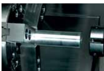
Position 4: Stangengreifer fährt linear vor die Stange, Signal: Spindeldrehung (die Bearbeitung kann von neuem beginnen)
