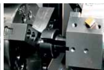
Position 2: Stangengreifer fährt linear im Eilgang (30 m/min) mit den entsprechenden Backen auf die Stange (ca. 4 mm sind dabei ausreichend), Signal: Futter automatisch öffnen
